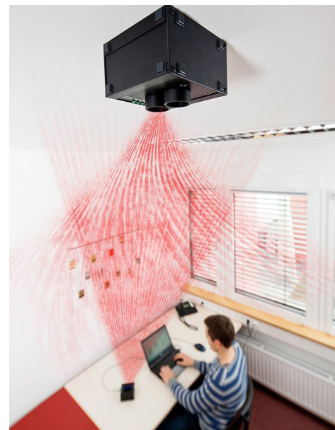
OWC-HotSpot: optisch drahtlose Kommunikation über große Distanzen in Echtzeit mit bis zu 1 Gigabit pro Sekunde. Quelle: Fraunhofer IPMS
